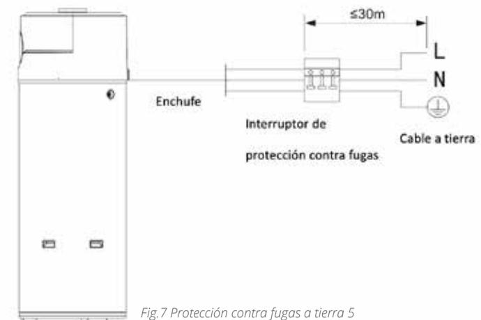
Fig.7 Protección contra fugas a tierra 5
